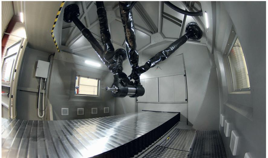
1 Blick in den Arbeitsraum der Hybrid-Werkzeugmaschine von Metrom und auf die eigensteife 5-Achs-Parallelkinematik für die additive und subtraktive Fertigung © Metrom
