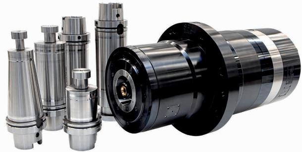
3 Beispielhafte Motorspindel von SPL des Typs SPL 2780.0 mit  $75 \text{ Nm}$  Drehmoment, Maximaldrehzahl  $18000 \text{ min}^{-1}$  und verschiedenen HSK-A100-Werkzeugaufnahmen © SPL
